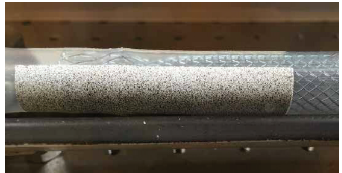
Figura 2. Provino: tubo in silicone con stent metallico al suo interno
